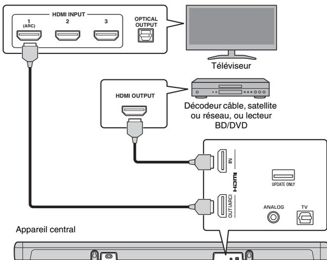
Si vous prévoyez de raccorder un téléviseur prenant en charge le Canal de retour audio (ARC), l'appareil pourra uniquement lire le son depuis le téléviseur si l'appareil central est raccorderé comme illustré ci-dessus. Voir le Mode d'emploi pour en savoir plus.
