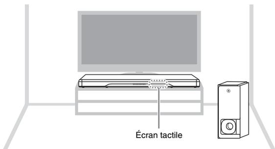
Installez l'appareil central sur le meuble de télévision et placez le caisson de basse à gauche ou à droite de l'appareil central. Orientez légèrement le caisson de basse vers le centre de la pièce pour éviter que le son ne se réfléchisse sur les murs.
