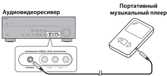
Подключите 3,5-мм стереокабель с миништырем (не включен в комплект поставки) к портативному музыкальному плееру и гнезду Аудиовидеоресивер PORTABLE (на передней панели), как показано на рисунке.
