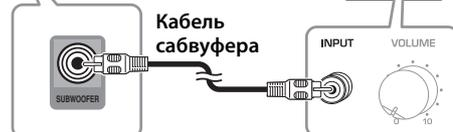
С помощью прилагаемого кабеля для сабвуфера соедините гнездо INPUT на сабвуфере и гнездо Аудиовидеоресивер SUBWOOFER.
