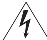
L'éclair avec une flèche à l'intérieur d'un triangle équilatéral est destiné à attirer l'attention de l'utilisateur sur la présence d'une « tension dangereuse » non isolée à l'intérieur de l'appareil, pouvant être suffisamment élevée pour constituer un risque d'électrocution.
